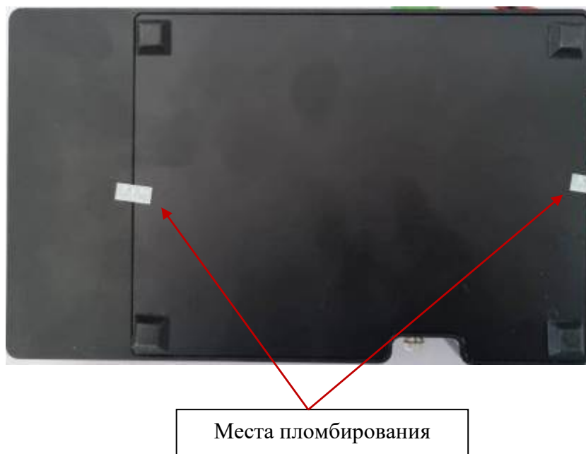
Рисунок 2 – Схема пломбирования от несанкционированного доступа (вид снизу)
