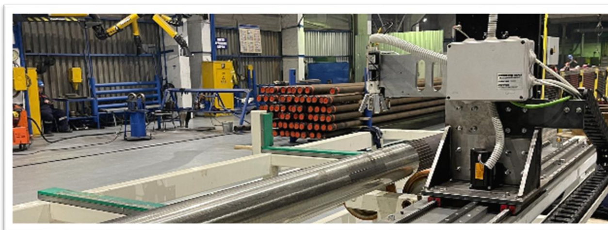
Рисунок 1 – Общий вид комплекса для измерений толщины зазоров скважинных фильтров оптико-лазерного АльфаИнспект
