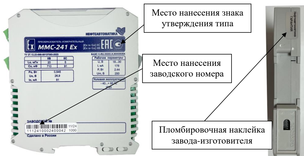
Рисунок 11 – Места нанесения знака утверждения типа, заводского номера и места ограничения доступа к местам настройки (регулировки)
