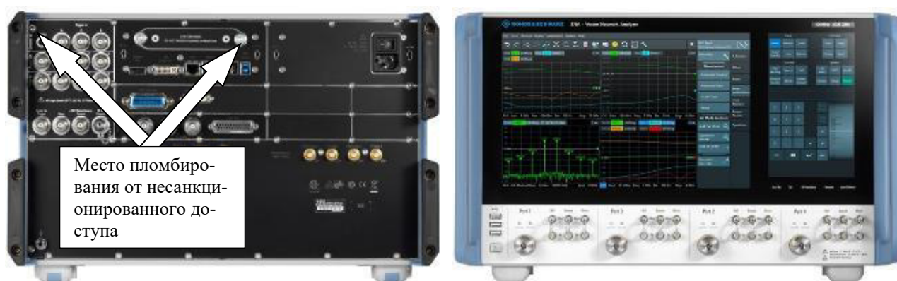
Рисунок 8 – Задняя панель ВАЦ с указанием мест пломбировки от несанкционированного доступа (слева), общий вид ВАЦ (справа)
