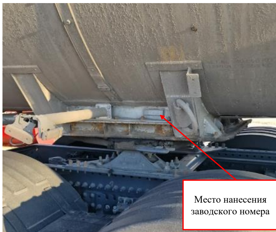
Рисунок 2 – Место нанесения заводского номера полуприцепа-цистерны VAN HOOL
