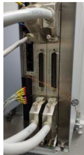
Рисунок 2 – Схема пломбировки задней панели FloBoss S600+
