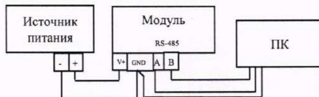
Рисунок 1 – Схема подключения модуля к источнику питания и ПК
