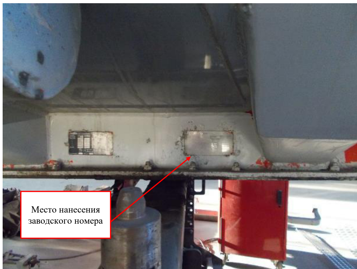
Рисунок 2 – Место нанесения заводского номера полуприцепа-цистерны BURG BPO 13-27
