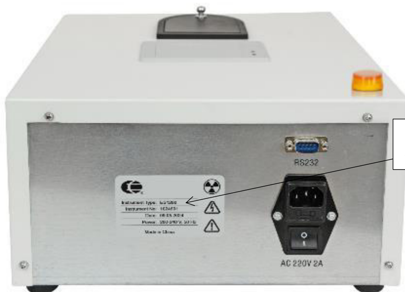
Рисунок 2 – Место нанесения заводского номера на анализаторы серы рентгенофлуоресцентные энергодисперсионные ES1260
