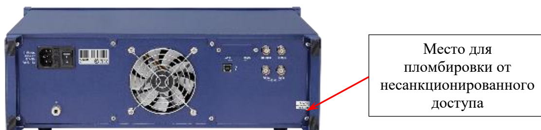
Рисунок 12 – Задняя панель ВАЦ с указанием мест пломбировки от несанкционированного доступа
