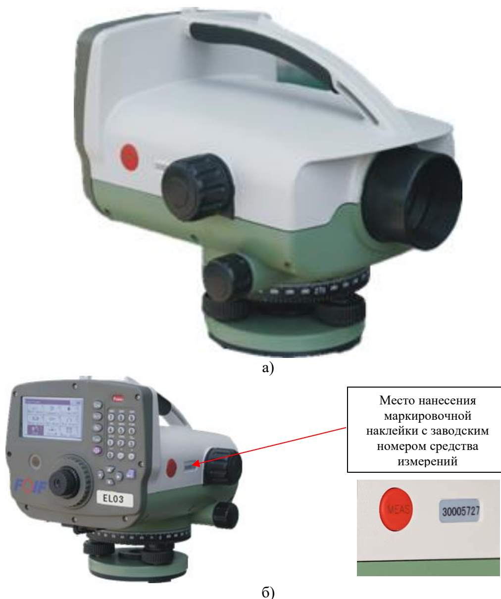
Рисунок 1 – Нивелиры электронные FOIF: а) общий вид; б) место размещения заводского номера
