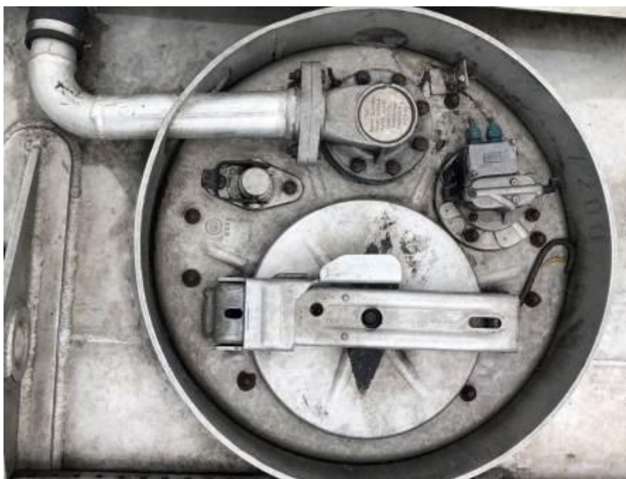
Рисунок 2 – Общий вид горловины ППЦ KASSBOHRER
