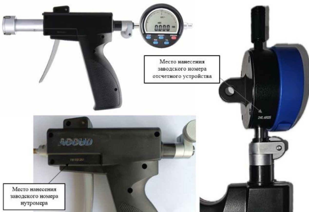
Рисунок 6 – Общий вид нутромеров модификации 365 с указанием места нанесения заводских номеров
