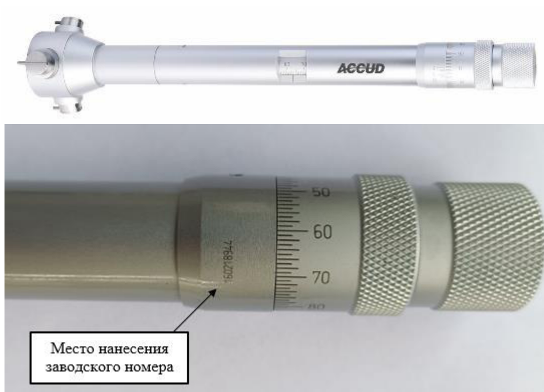
Рисунок 4 – Общий вид нутромеров модификации 363 с указанием места нанесения заводского номера
