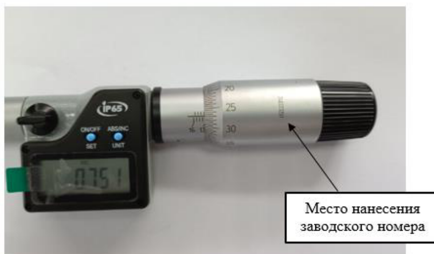
Рисунок 2 – Общий вид нутромеров модификации 361 с указанием места нанесения заводского номера
