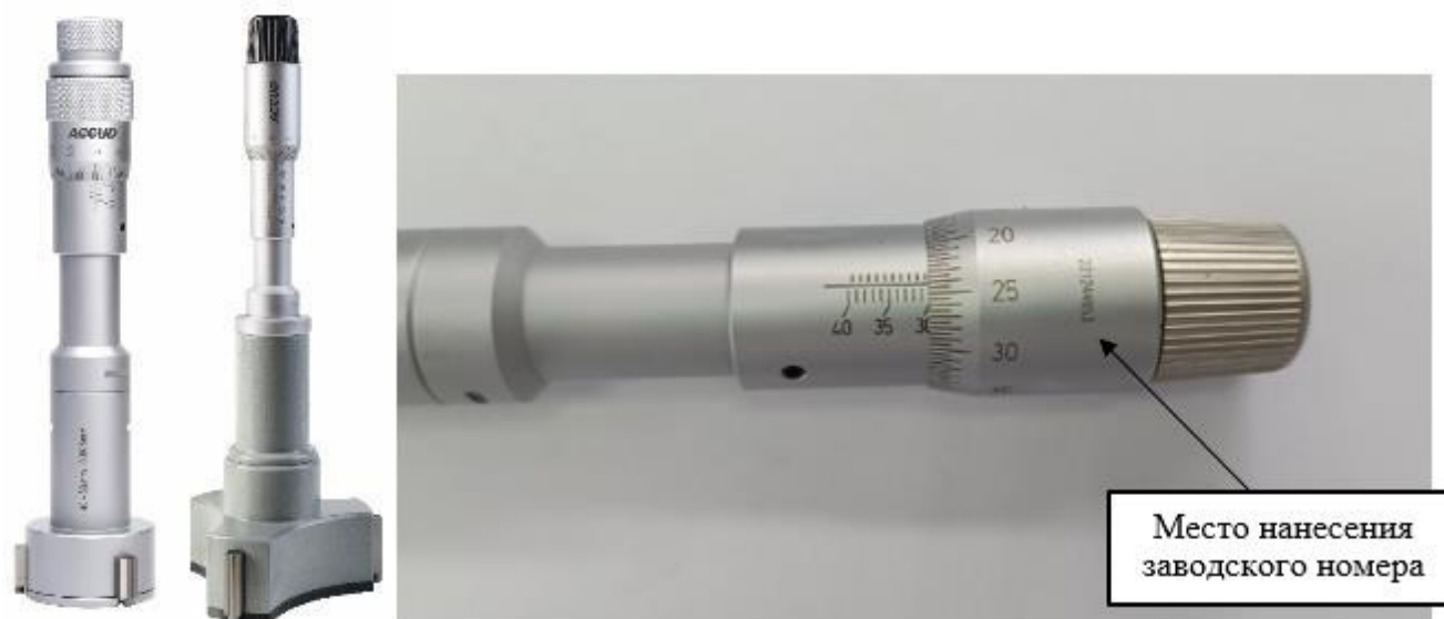
Рисунок 3 – Общий вид нутромеров модификации 362 с указанием места нанесения заводского номера
