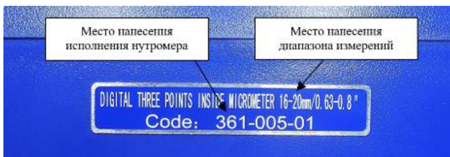
Рисунок 8 – Общий вид шильда с указанием мест нанесения исполнения нутромера и диапазона измерений
