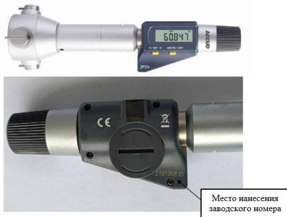
Рисунок 5 – Общий вид нутромеров модификации 364 с указанием места нанесения заводского номера
