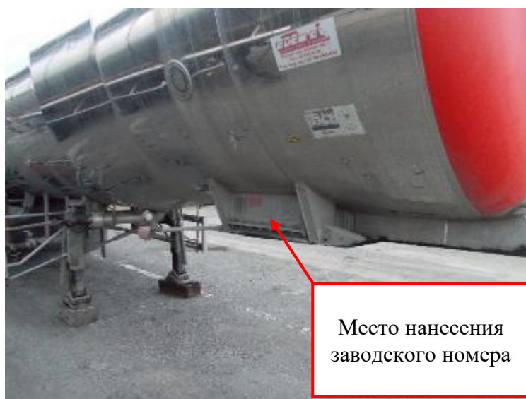
Рисунок 2 – Место нанесения заводского номера полуприцепа-цистерны MAGYAR
