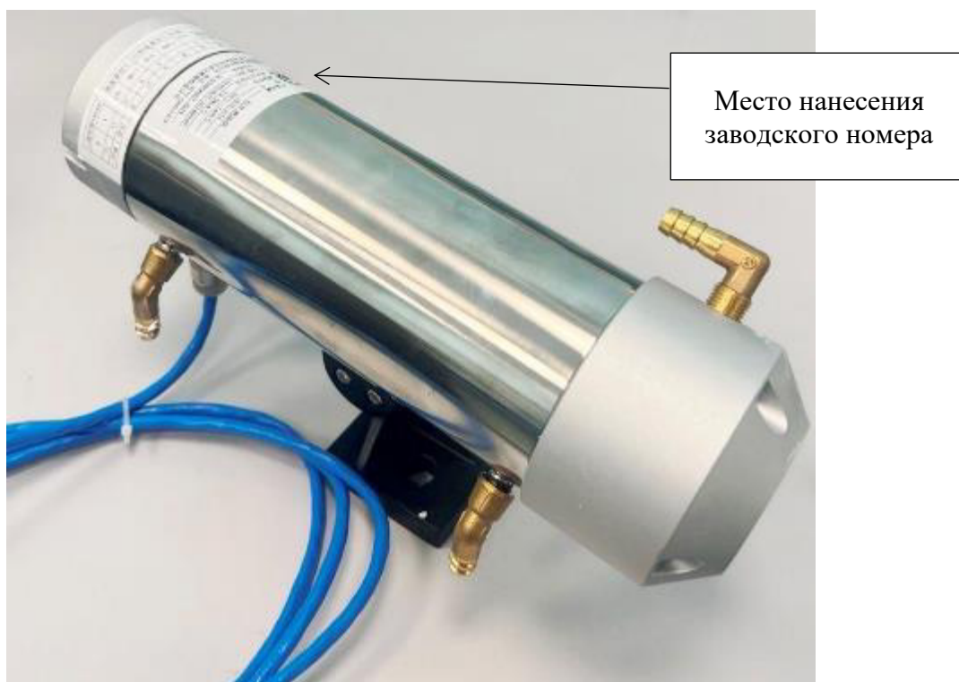
Рисунок 2 – Общий вид пирометров инфракрасных стационарных DCTQ-3514 с применением контура водяного охлаждения
