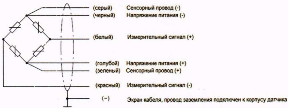
Рисунок 1 – Схем подключения датчика
