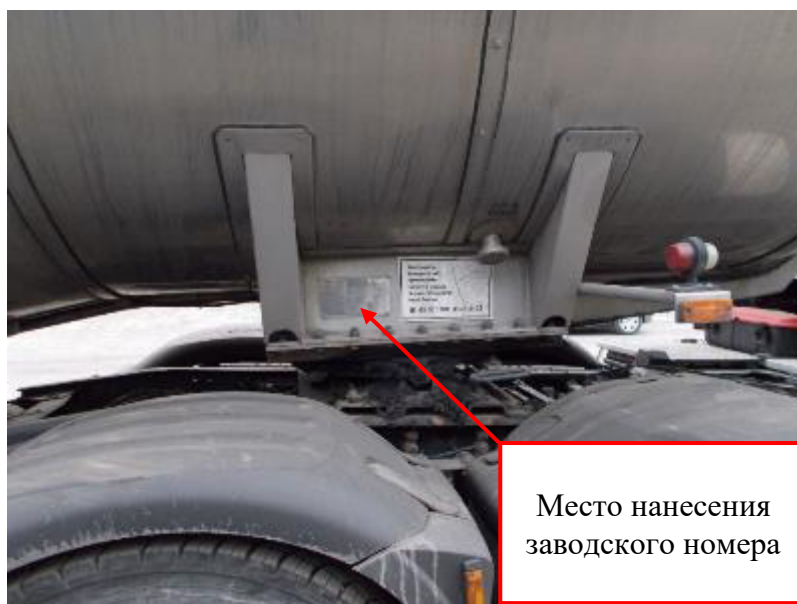
Рисунок 2 – Место нанесения заводского номера полуприцепа-цистерны PARCISA CA-3ESSD 19
