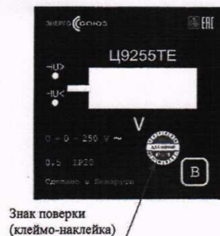
Рисунок 2.6 – Схема с указанием места для нанесения знака поверки на преобразователи Ц9254ТЕ, Ц9255ТЕ, Ц9256ТЕ, Ц9257ТЕ, Ц9258ТЕ, Ц9259ТЕ, Ц9260ТЕ с однострочной индикацией
