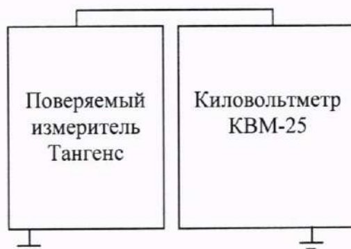
Рисунок 3 – Схема проверки абсолютной погрешности воспроизведений напряжения постоянного тока
