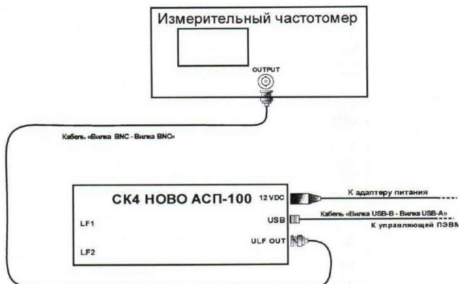
Рисунок 7 - Схема подключения для определения пределов допускаемой относительной погрешности установки частоты встроенного генератора
