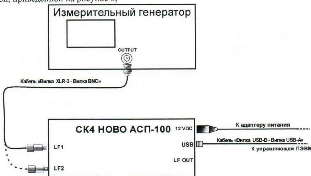
Рисунок 5 – Схема подключения для определения минимального значения полосы пропускания измерительного фильтра
