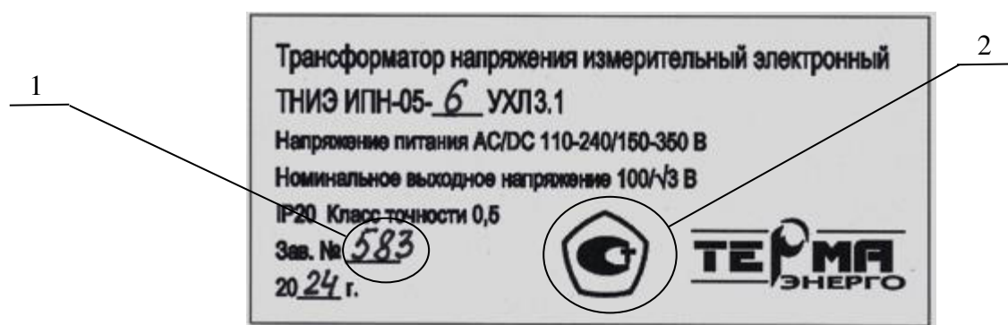
Рисунок 1 – Общий вид маркировочной таблички: 1 – место нанесения заводского номера, 2 – место нанесения знака утверждения типа.
