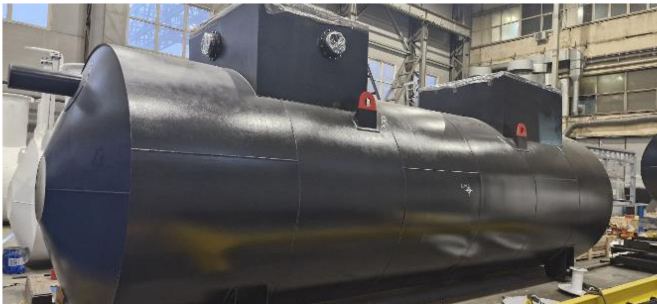
Рисунок 3 – Общий вид резервуара РГСП-Н50-1900А1К0-2-Б-2-У-С0 с зав.№ 8661
