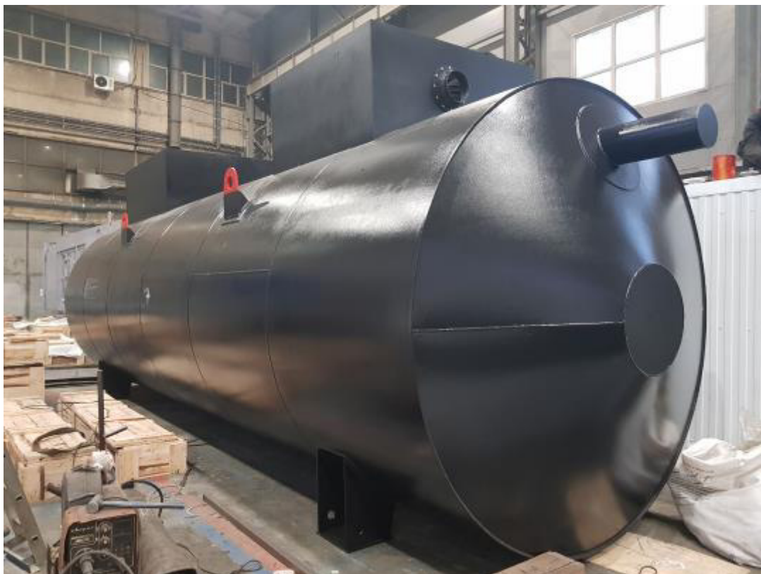
Рисунок 3 – Общий вид резервуаров РГСП
