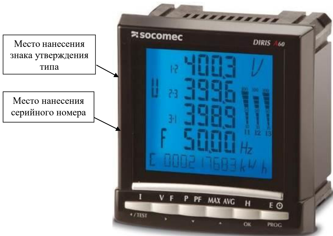
Рисунок 5 – Общий вид приборов DIRIS A60 с указанием места нанесения знака утверждения типа, места нанесения серийного номера
