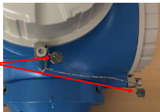
Место нанесения знака поверки на электронный преобразователь Promass
