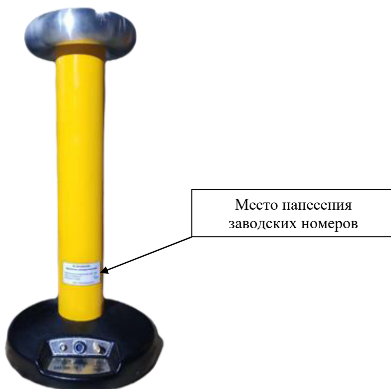
Рисунок 10 – Общий вид делителя измерительного. Обозначение места нанесения заводских номеров
