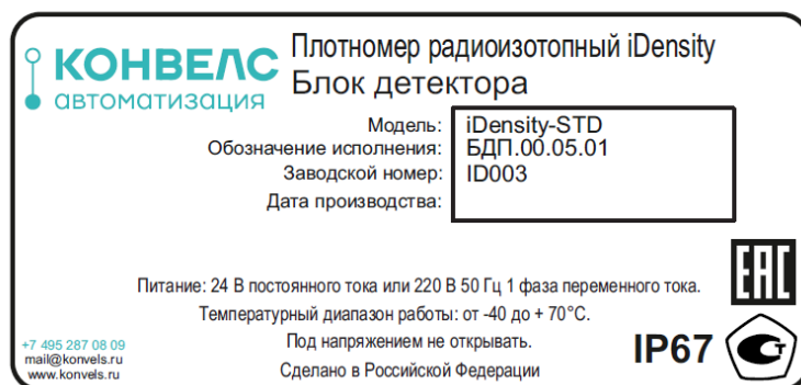
Рисунок 2 – Место нанесения знака утверждения типа и заводского номера
