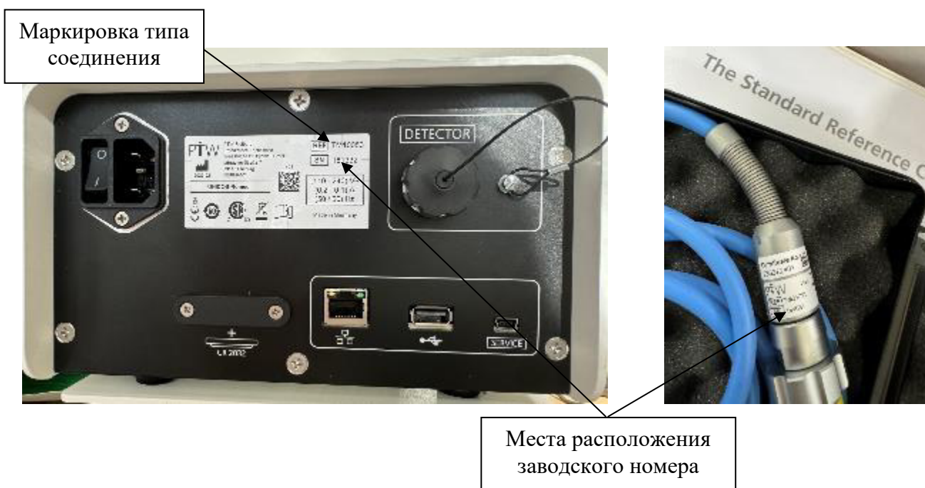
Рисунок 11 – Вид места расположения заводского номера на электрометре и ИК
