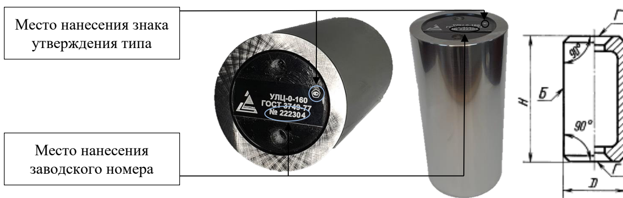
Р и с у н о к 2 – Общий вид угольников УЛП, обозначение основных размеров и поверхностей
