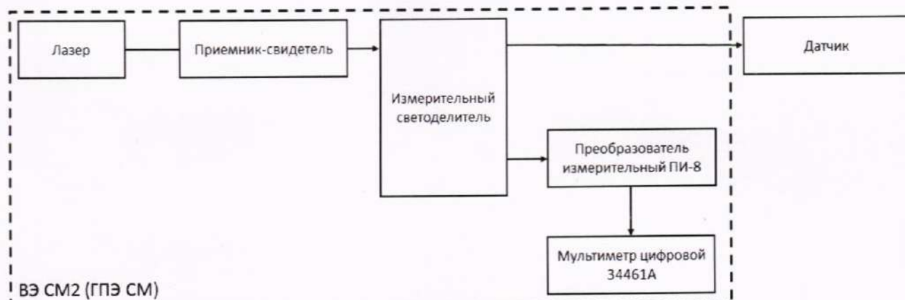
Рисунок 2 – Блок-схема подключения приборов для измерений с помощью ВЭ СМ2 (ГПЭ СМ1)
