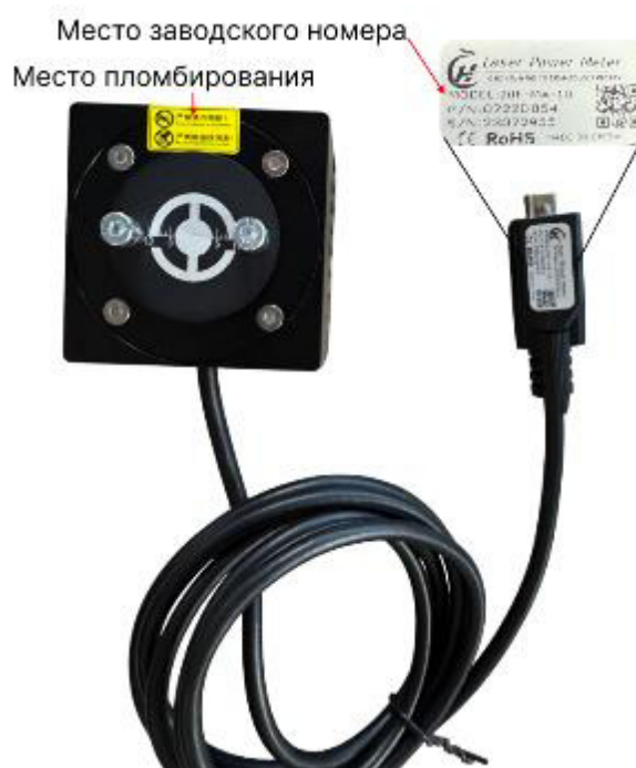
Рисунок 2 – Схема пломбировки от несанкционированного доступа, обозначение места нанесения маркировки, места нанесения заводского номера
