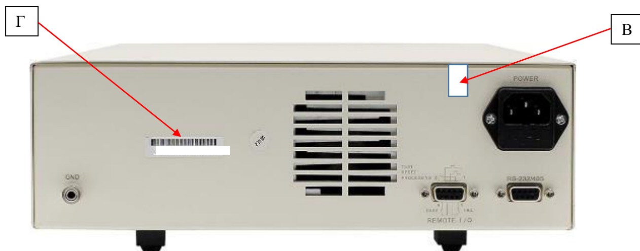
Рисунок 2 – Схема опломбирования от несанкционированного доступа (В) и места нанесения серийного номера (Г)
