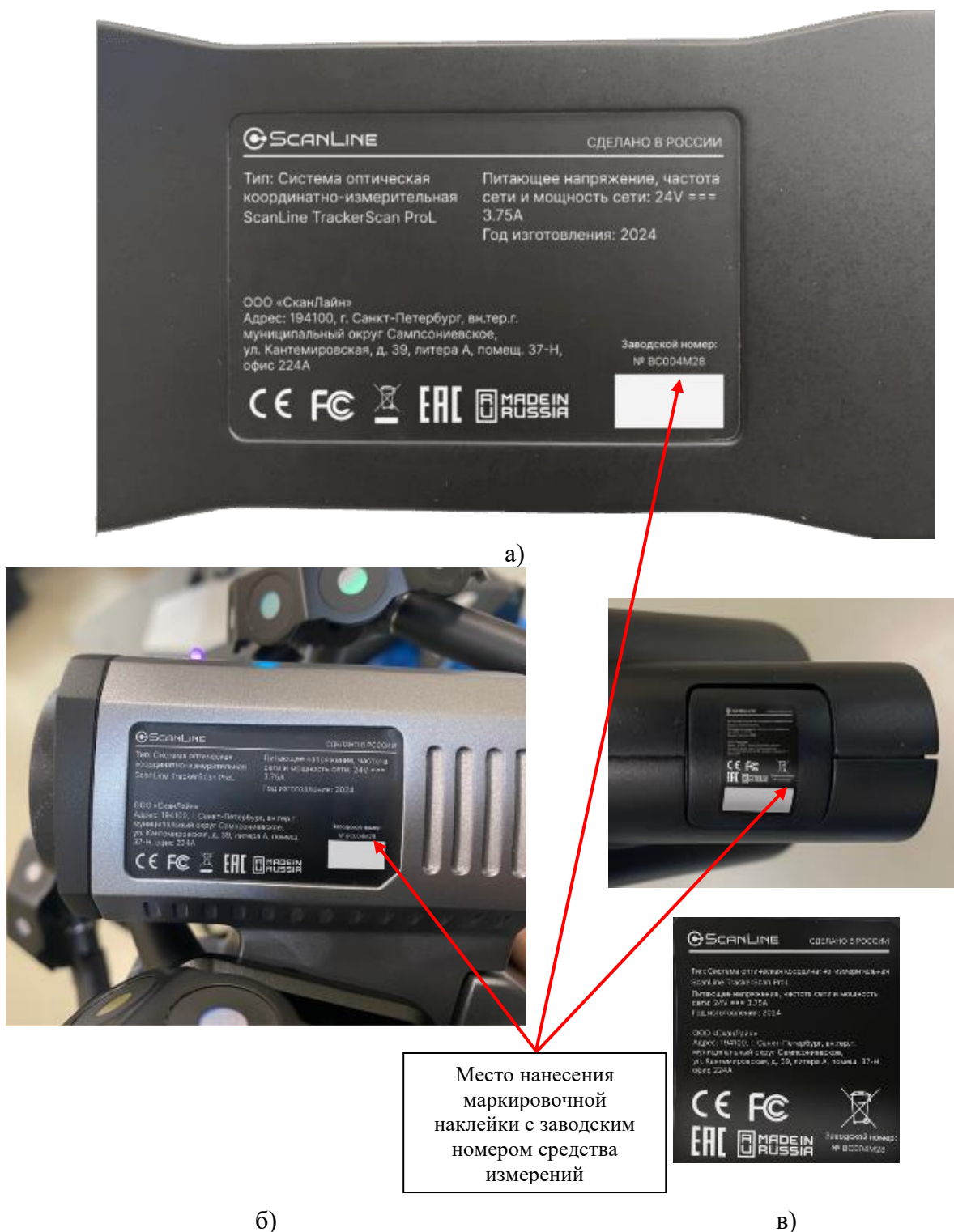
Рисунок 2 – Места нанесения маркировочных наклеек с заводским номером средства измерений на основные элементы систем: а) оптическая система слежения; б) ручной лазерный сканер; в) беспроводной измерительный щуп
