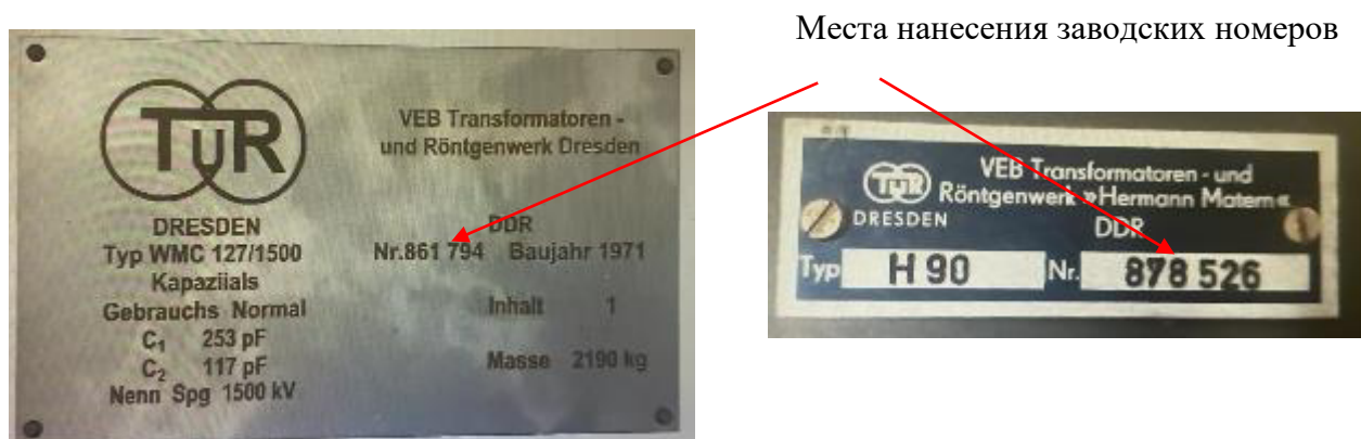
Рисунок 3 – Обозначение мест нанесения заводских номеров
