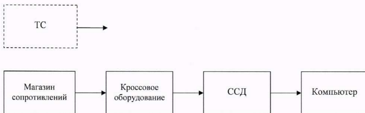
а) Схема определения метрологических характеристик комплектным способом
