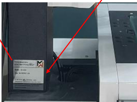
Рисунок 2 – Места нанесения заводского номера и знака утверждения типа на микроскопы
