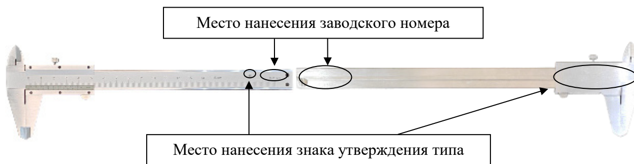
Р и с у н о к 1 – Места нанесения заводского номера и знака утверждения типа
