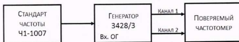
Рисунок 4 – Схема определения погрешности измерений временных интервалов
