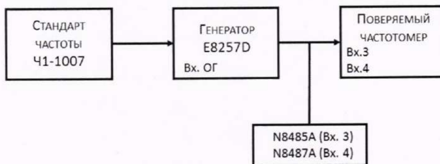
Рисунок 3 – Схема определения диапазона измеряемых частот, чувствительности и абсолютной погрешности измерений частоты сигнала для каналов 3 и 4
