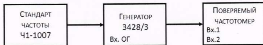
Рисунок 2 – Схема определения диапазона измеряемых частот, чувствительности и абсолютной погрешности измерений частоты сигнала для каналов 1 и 2
