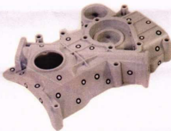
Рисунок 2 - Общий вид меток и пример их нанесения на объект сканирования.
