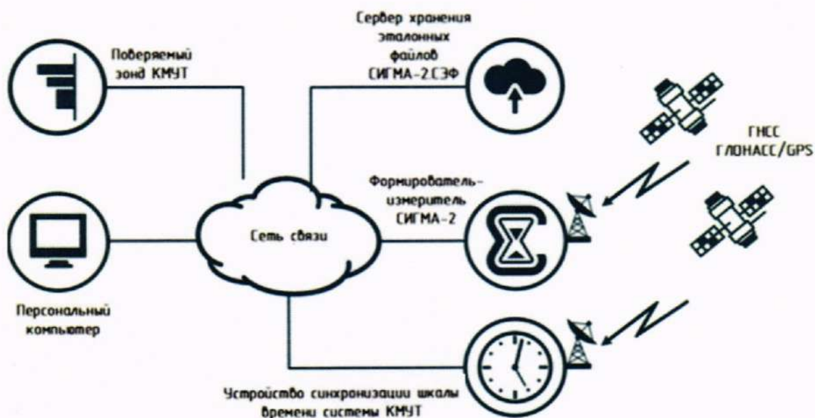
Рисунок 7 – Схема измерений при поверке зонда КМУТ
