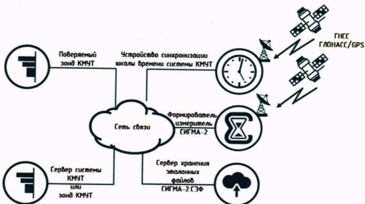
Рисунок 2 – Схема измерений для проведения опробования при первичной поверке
