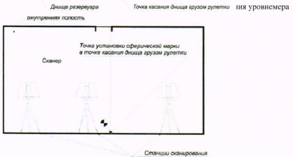
Рисунок А.2 - Схема сканирования внутренней полости резервуара
