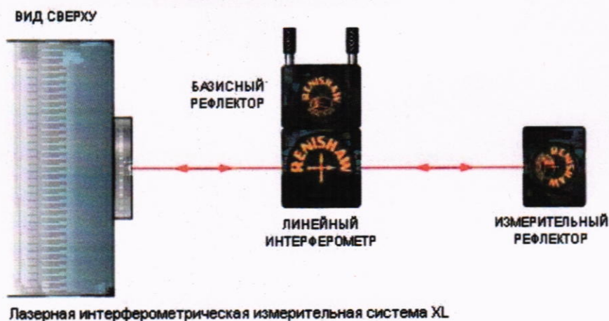
Рисунок 1 – Схема измерения параметра по оси X
