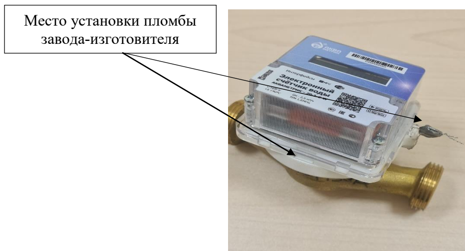
Рисунок 2 – Схема пломбировки от несанкционированного доступа
