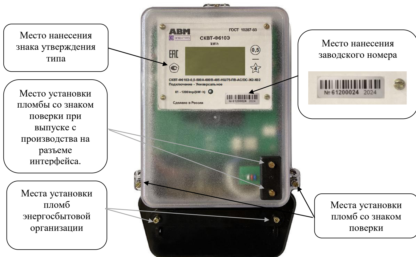
Рисунок 2 – Общий вид счетчика СКБТ-Φ610Э в корпусе К02
