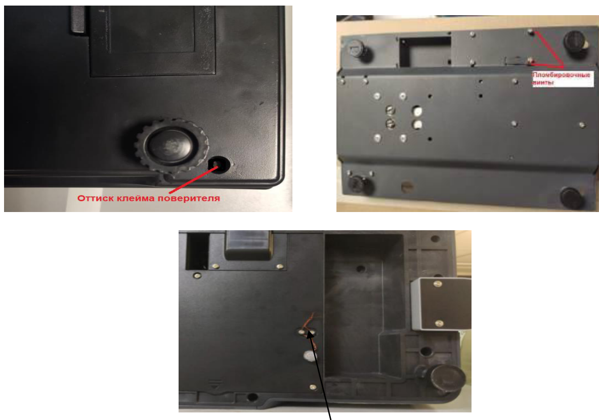
Пломба, место нанесения знака поверки
