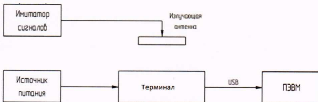
Рисунок 1 - Схема проведения измерений при поверке
