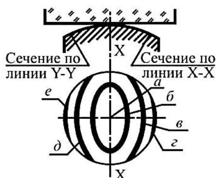
Рисунок 2 – Изображение картины интерференционных полос (колец) при радиусе кривизны измерительной поверхности в сечении X-X большем, чем в сечении Y-Y
