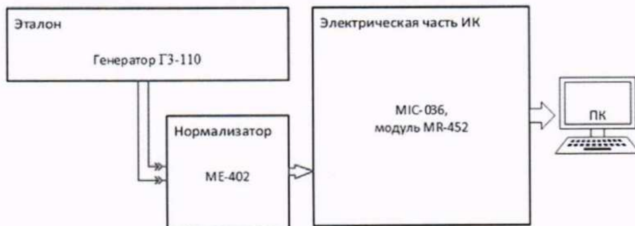
Рисунок 17 – Схема поверки ИК частоты переменного тока, соответствующего частоте вращения ротора
