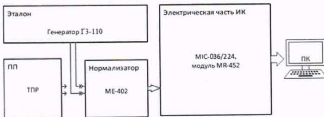
Рисунок 18 – Схема поверки ИК объемного расхода
