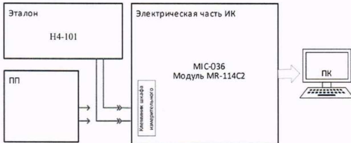
Рисунок 28 – Схема поверки ИК напряжения постоянного тока, соответствующего значениям виброперемещения
