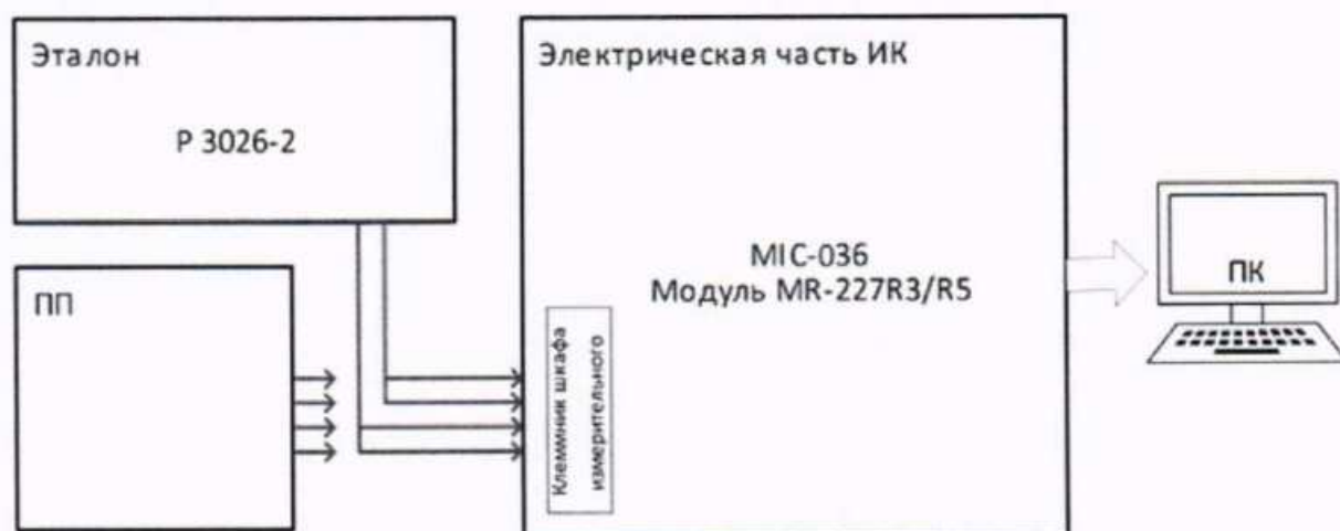
Рисунок 24 – Схема поверки ИК сопротивления постоянному току, соответствующего значениям температуры жидких и газообразных сред в диапазоне преобразований первичных измерительных преобразователей терморезистивного типа 100П
