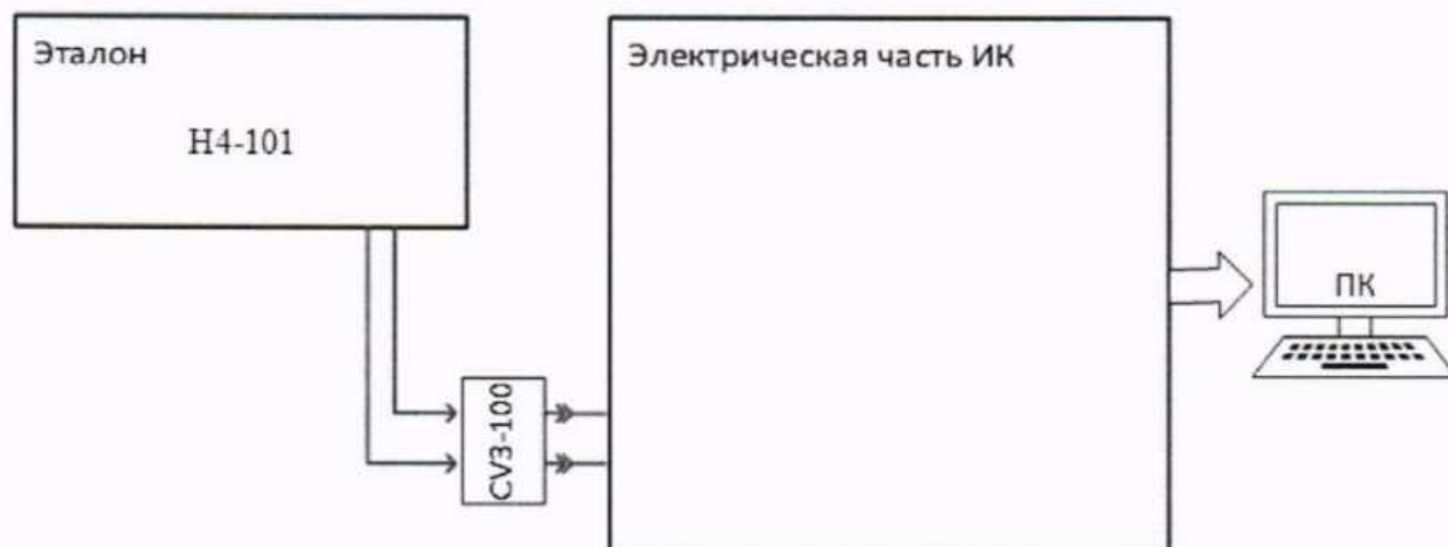
Рисунок 29 – Схема поверки электрической части ИК напряжения постоянного тока бортсети
