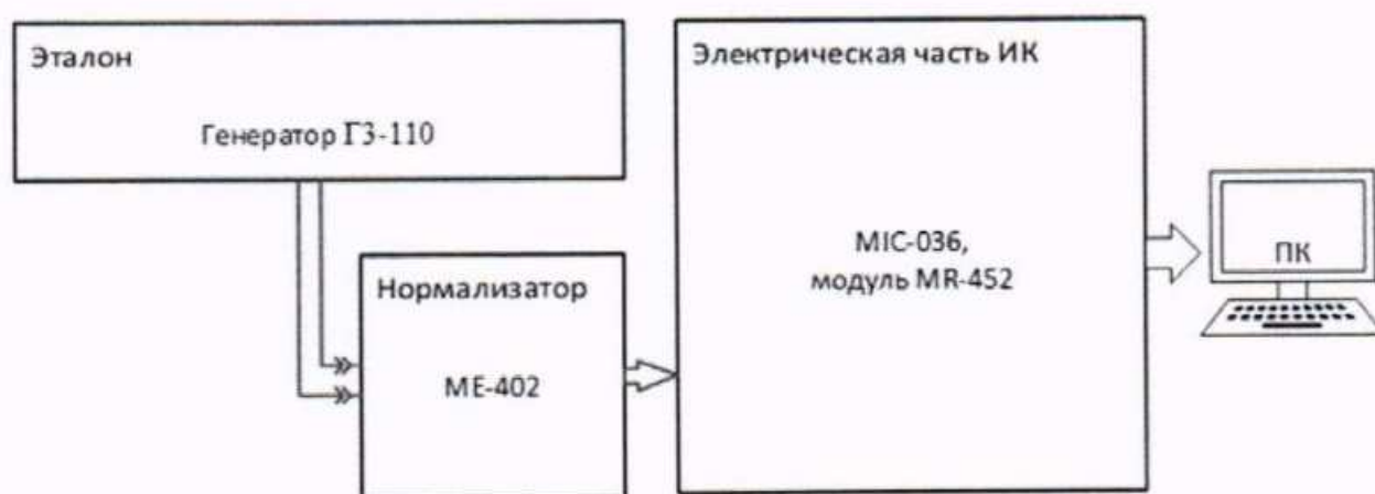
Рисунок 31 – Схема поверки ИК частоты переменного трехфазного тока
