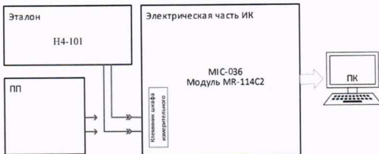
Рисунок 19 – Схема поверки ИК давления абсолютного, относительного и вакуумметрического газообразных и жидких сред
