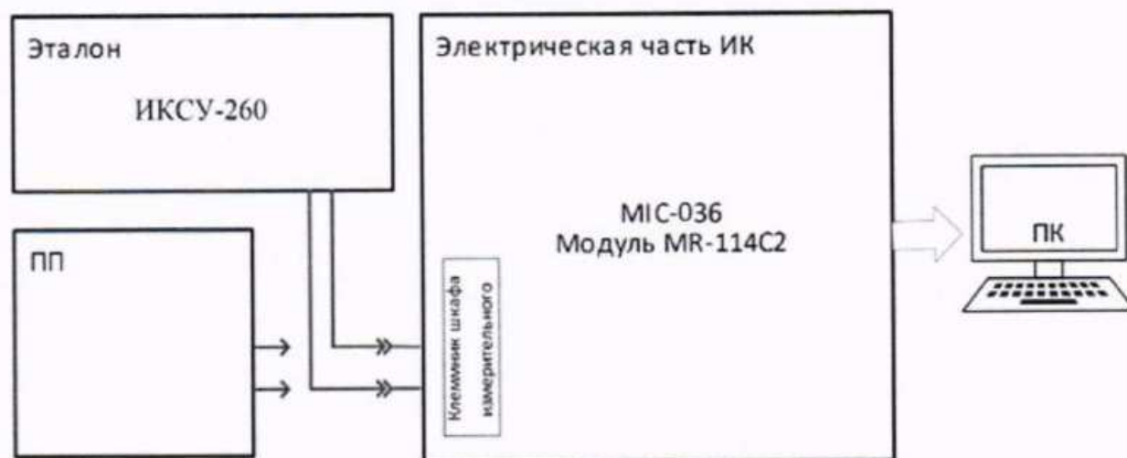
Рисунок 22 – Схема поверки ИК температуры, измеренной ПП термоэлектрического типа ХК (L)
