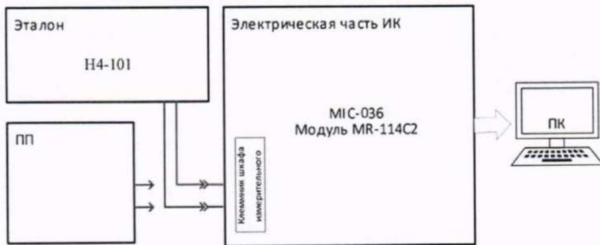
Рисунок 33 – Схема поверки ИК напряжения постоянного тока, соответствующего значениям угла поворота
