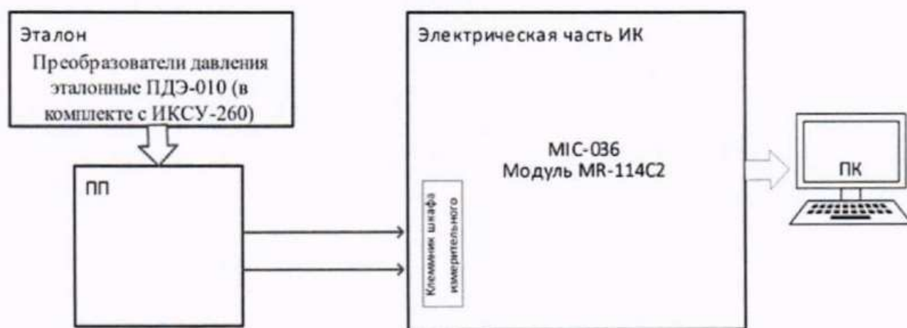
Рисунок 20 – Схема поверки ИК давления газов и жидкостей комплектным способом
