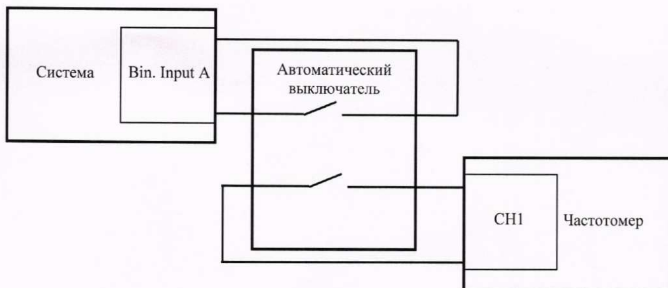
Рисунок 7 – Структурная схема определения погрешности измерений интервалов времени
