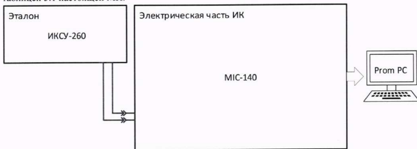
Рисунок 17 – Схема поверки напряжения постоянного тока, соответствующего температуре
