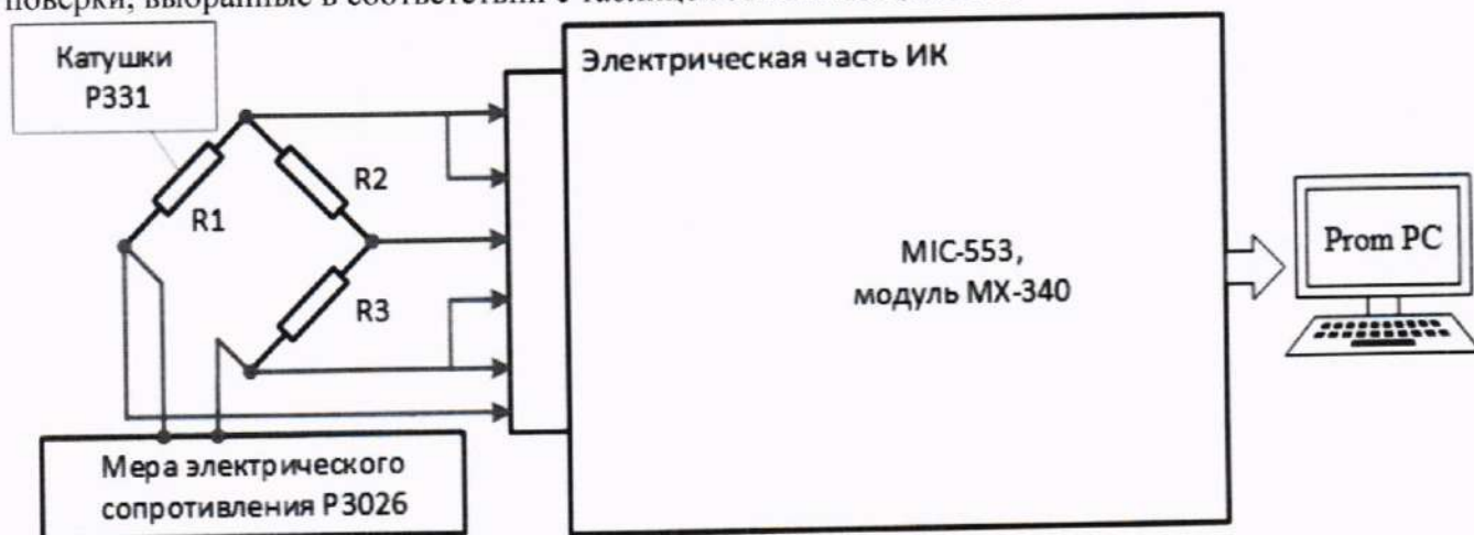
Рисунок 23 – Схема поверки ИК относительного напряжения тензодатчиков
