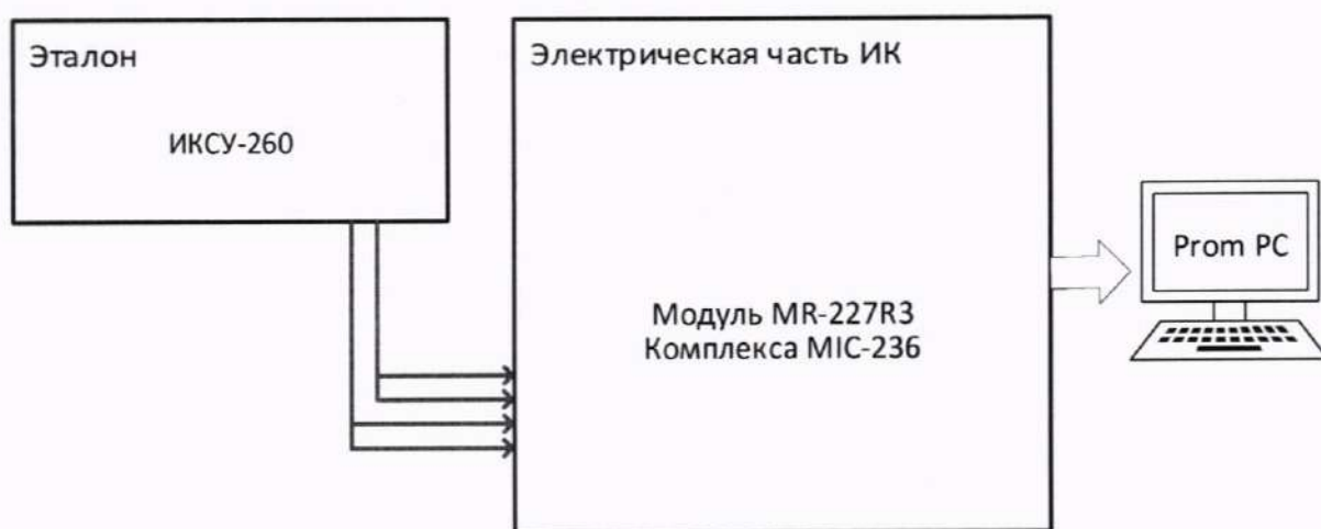
Рисунок 18 – Схема поверки ИК сопротивления постоянному току, соответствующего температуре
