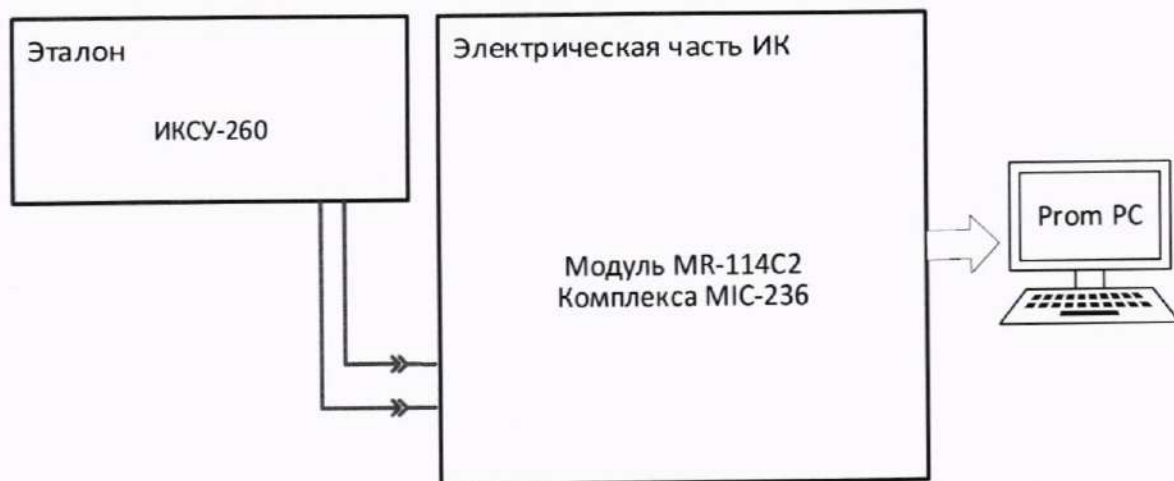
Рисунок 22 – Схема поверки ИК силы постоянного тока
