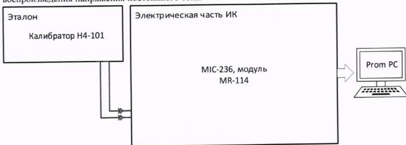
Рисунок 21 – Схема поверки ИК напряжения постоянного тока
